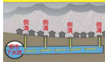
雨水バイパス管のイメージ。大雨の際、側溝から雨水がバイパス管に流れ込み、冠水被害を軽減します。
